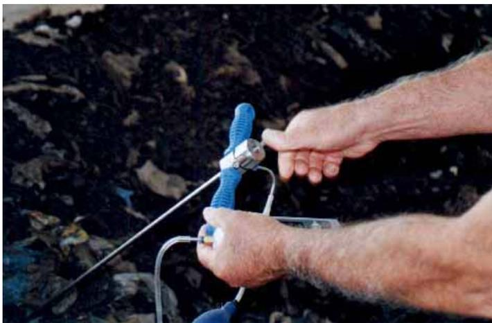
La concentración de  $O_2$  en las pilas de compostaje es uno de los parámetros que controla la fermentación aeróbica durante el proceso de maduración de la materia orgánica. Los niveles de  $O_2$  determinarán que las reacciones químicas sean las correctas.
