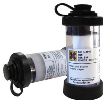
Frasco de solución salina saturada para el ajuste de higrómetros con sonda de Ø 13 mm.
