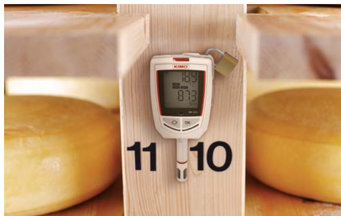
Contrôle en humidité relative et température en cave d'affinage, assuré par un KT220 fixé sur platine de fixation et sécurisé par un cadenas dans le cadre d'une cartographie.
