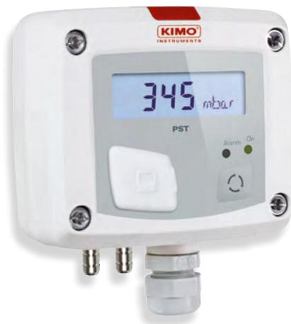
Rápidos de instalar y fáciles de configurar, los transmisores de presión permiten activar una alarma cuando se supera un umbral previamente establecido, y enviar seguidamente esa información mediante un relé. La configuración de la alarma se realiza mediante un pulsador o a través del software LCC-S, compatible con las gamas de transmisores de presión 110, 210 y 310.
